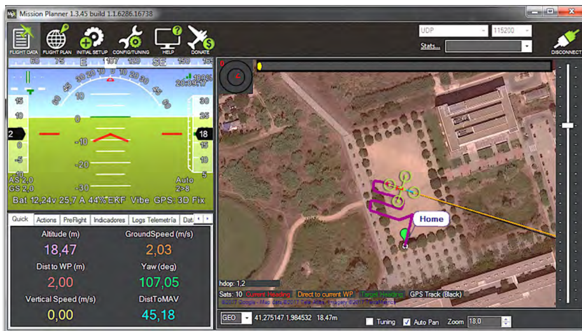
Figura 3. 5: Imagen extraída de Mission Planner, dron realizando la misión de observación.
