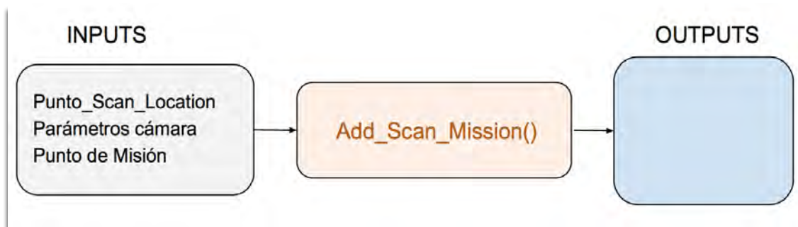
Figura 2. 27:Esquema de inputs y outputs de la función Add_Scan_Mission() .
