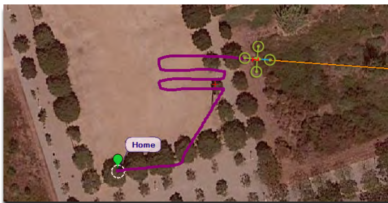
Figura 2. 22: Scan no rotado según el heading.
