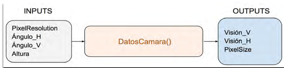
Figura 2. 4:Esquema de inputs y outputs de la función DatosCamara().
