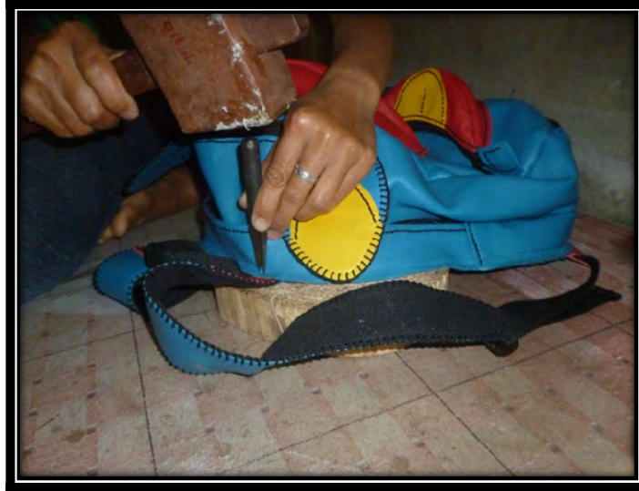
Gambar CXXXVII: Proses pengeplongan pada proses perakitan akhir (Sumber: dokumen Jannah, Agustus 2015)
