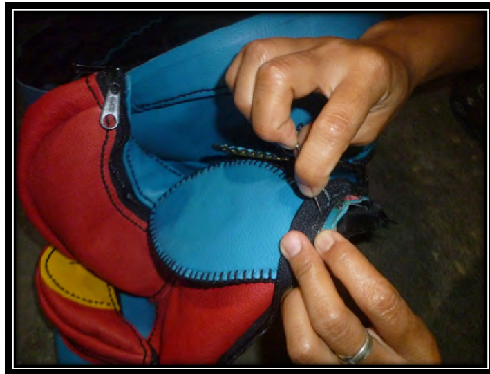
Gambar CXXXV: Proses penjahitan bagian depan tas dengan bagian samping tas
